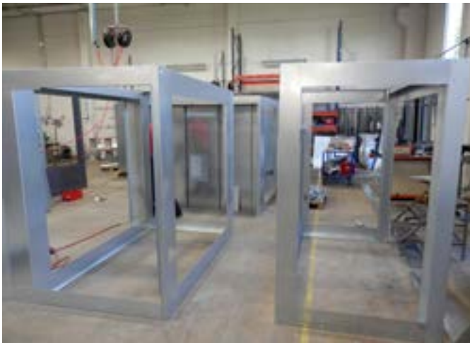
Elkamon ulkomuuntamoiden ohutlevyosat tehdään tilausohjautuvasti suoraan kokoonpanojärjestyksessä Elsteelillä.
